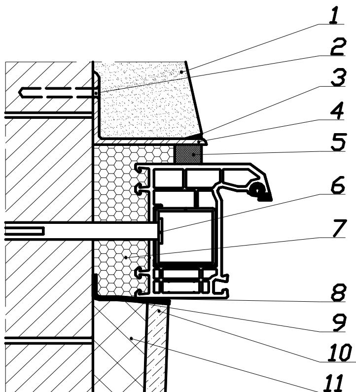
1 – штукатурный слой наружного откоса (с фаской для слоя герметика); 2 – строительный шуруп; 3 – герметик; 4 – фальшчетверть из уголка; 5 – изоляционная саморасширяющаяся паропроницаемая лента (ПСУЛ); 6 – рамный дюбель; 7 – пенный утеплитель; 8 – герметик; 9 – пароизоляционная лента; 10 – элемент отделки внутреннего откоса; 11 – полость между неутепленной однослойной стеной и элементом отделки откоса (рекомендуется заполнять теплоизоляционным материалом)
