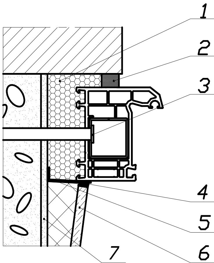
1 – пенный утеплитель; 2 – изоляционная саморасширяющаяся паропроницаемая лента (ПСУЛ); 3 – рамный дюбель; 4 – герметик; 5 – пароизоляционная лента; 6 – панель отделки внутреннего откоса; 7 – штукатурный выравнивающий слой внутреннего откоса
