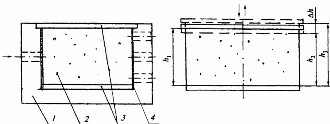
1 – корпус устройства; 2 – образец материала; 3 – алюминиевые пластины толщиной не менее 2,0 мм; 4 – смазка;
