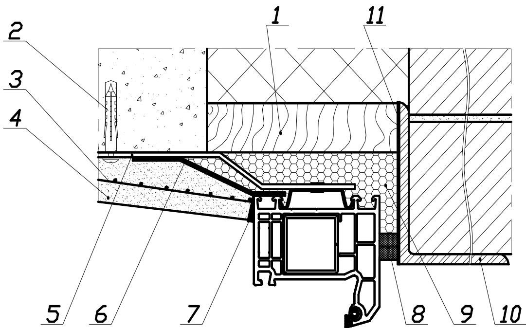
1 – вкладыш из атисептированного пиломатериала; 2 – дюбель со стопорным шурупом; 3 – армирующая сетка; 4 – штукатурный слой внутреннего откоса (с фаской для слоя герметика), возможна отделка листовым материалом (влагостойкая панель); 5 – гибкая анкерная пластина; 6 – пароизоляционная лента; 7 – герметик; 8 – изоляционная саморасширяющаяся паропроницаемая лента (ПСУЛ); 9 – пенный утеплитель; 10 – стальная перемычка; 11 – антикоррозийное покрытие
