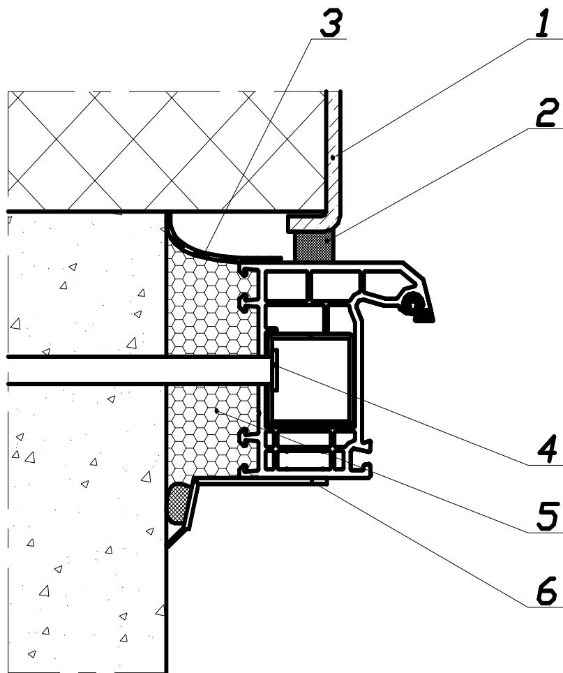
1 – элемент отделки наружного оконного откоса; 2 – изоляционная саморасширяющаяся паропроницаемая лента (ПСУЛ); 3 – водоизоляционная паропроницаемая лента; 4 – рамный дюбель; 5 – пенный утеплитель; 6 – нашельник из ПВХ в комбинации с пароизоляционным вкладышем
