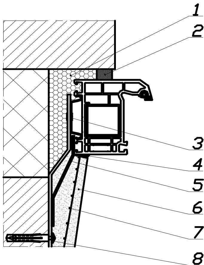
1 – пенный утеплитель; 2 – изоляционная саморасширяющаяся паропроницаемая лента (ПСУЛ); 3 – гибкая анкерная пластина; 4 – герметик; 5 – пароизоляционная лента; 6 – штукатурный слой внутреннего откоса (с фаской для слоя герметика); 7 – армирующая сетка; 8 – дюbelь со стопорным шурупом
